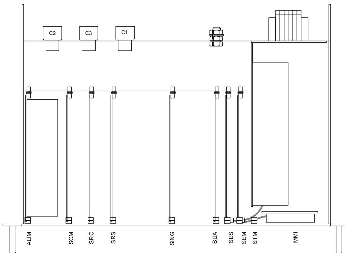
Figura 3 Vista dall'alto del pannello DMC905 (DV905A2)
